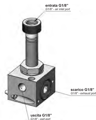
schema di connessione per versione NA connection scheme for NO version
